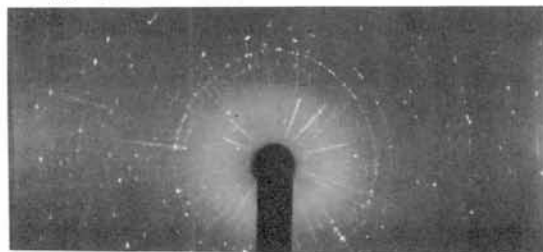
かんらん石のX線回折写真 微結晶の集合を示している。
