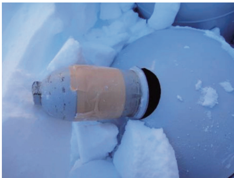
図 14 折損したプロパンガスボンベ Fig. 14. Broken propane-gas cylinder.
