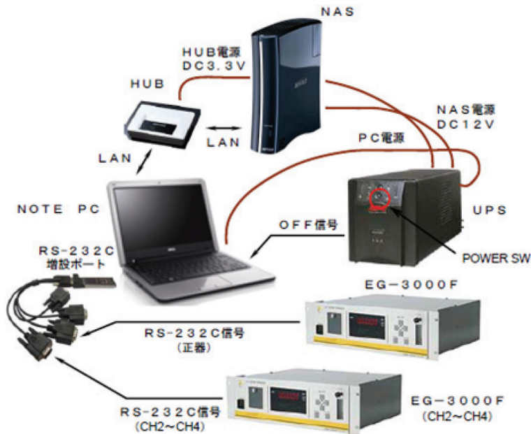
図6 更新した地上オゾン濃度測定装置（荏原実業製）
