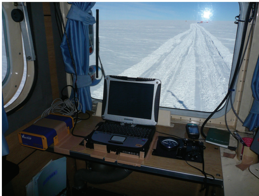
図 12 雪上車の助手席に設置した GPS コンパス（左側の青色の機器）とナビゲーション補助用 PC
