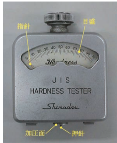
図 5 試験に用いたスプリング式硬さ試験機
