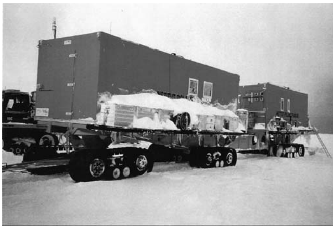
図 28 フランス隊のゴムクローラートレーラー Fig. 28. Rubber crawler trailer of French party.
