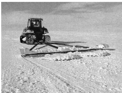
図 19 拡幅棒を利用した整地 Fig. 19. Grooming using a spread bar.
