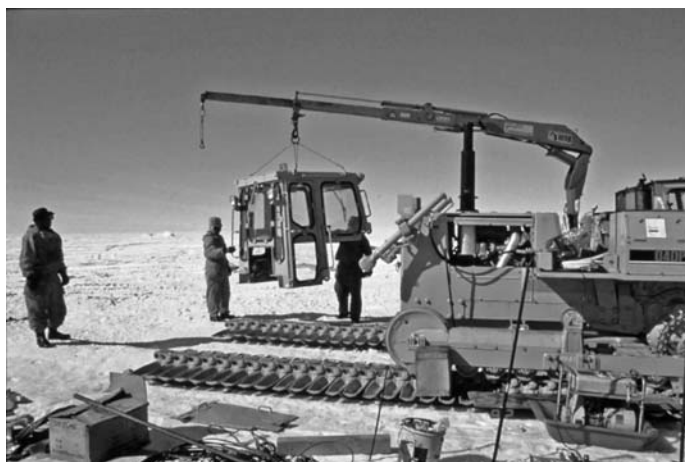
図 3 小松 D40PL-5A の S16 地点での組み立て
