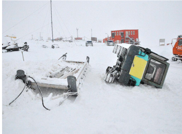
図Ⅲ.6.2.4-3 横転したミニバックホー
