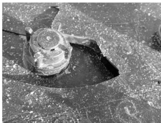
写真Ⅲ. 3. 3. 1. 4-1 バッテリーカバー割れ
