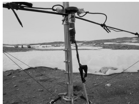
写真Ⅲ.3.3.1.3-2 コネクターから抜けた ケーブルの例
