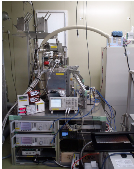
写真Ⅲ. 3. 1. 1. 2-1 ミリ波分光観測装置
