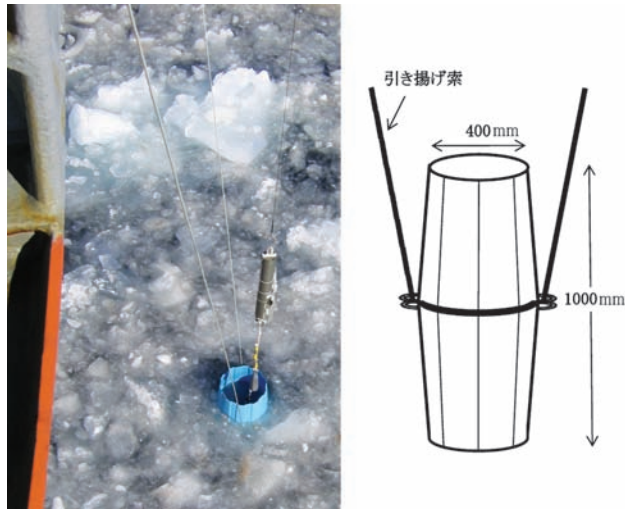
図 2 第 48 次隊で用いたポリバケツによる“アイスフェンス”のプロトタイプ。 (2006 年 12 月 18 日に 68°41'S, 38°42'E の観測点において撮影)。 Fig. 2. Prototype of “ice-fence” in the sea-ice during the JARE-48th cruise.
