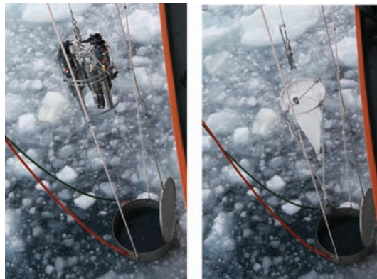
図7 氷海内モニタリング観測で用いるメモリー式CTDと自動採水器(左図)および閉鎖式プランクトンネット(右図)。(2012年2月14日(第53次隊)に68°57'S, 39°05'Eの観測点において撮影)。
