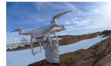
小型UAVで基準点周辺の撮影 (基準点明細表に活用)
