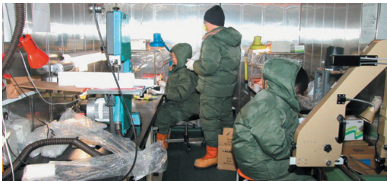
低温実験室での氷床コア処理
