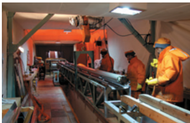
ドームふじ基地内の深層掘削施設とドリル（全長13.8m）
