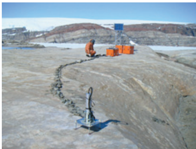
スカーレンでの衛星通信機能付き無人磁力計の設置風景
