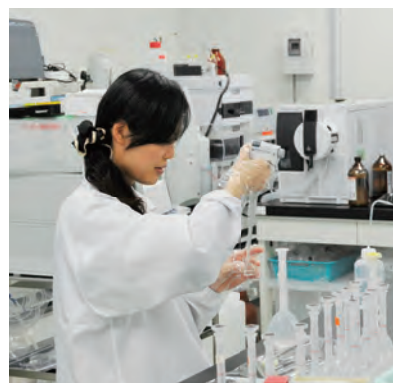
イオンクロマトグラフを用いた氷床コアの分析
