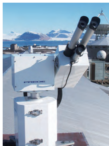
北極スバルバル、ニーオルスンにてエアロゾルを観測するスカイラジオメータ
