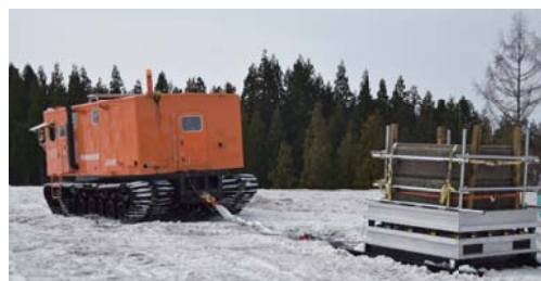
内陸旅行用の大型雪上車による、防振装置の牽引実験
