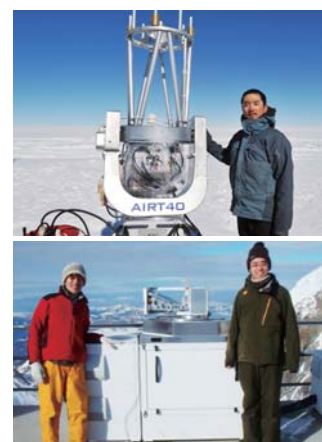
上：ドームふじ基地に設置した40cm 赤外線望遠鏡（東北大学） 下：試験中の30cm可搬型サブミリ波 望遠鏡（筑波大学）
