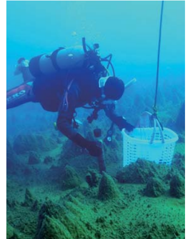
スキューバダイビングによる南極湖沼底での堆積物コア採取
