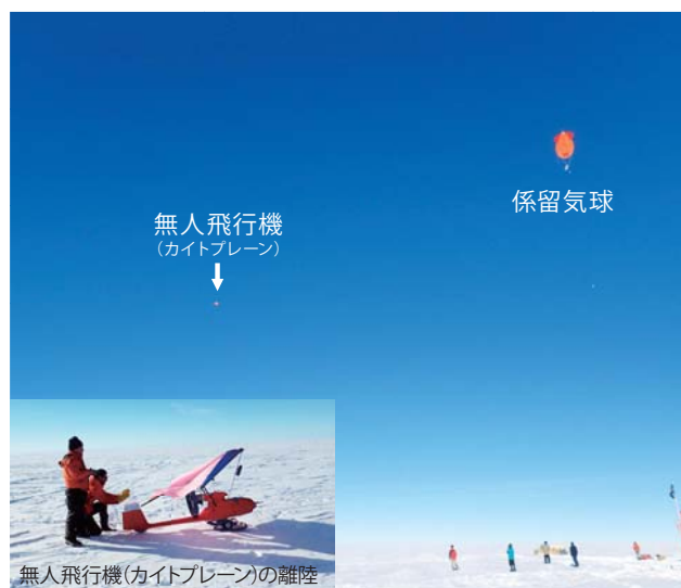
無人飛行機 (UAV) と係留気球を使った南極氷床上の大気観測
