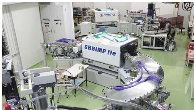
鉱物の年代測定を行う二次イオン質量分析計（SHRIMP）
