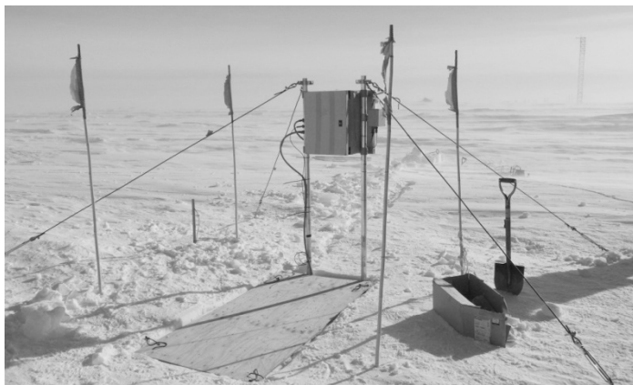
写真Ⅲ. 7. 4. 1-10 バッテリーボックスの穴はコンパネを被せた
