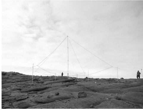
写真Ⅲ.3.2.4.3-1 新設された ELF/VLF 帯受信アンテナ
