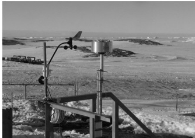
写真Ⅲ. 3. 4. 1. 4-1 高所観測実験用センサー（センサー高変更後）
